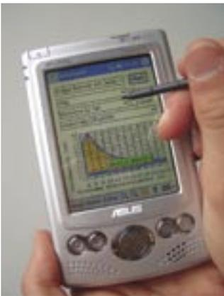
Mit der Software pro. PocketSchoSpeed.net kann man die Berechnung einer Abgasanlage nach DIN EN 13384/1 durchführen. Auf dem Touch Screen wird der Brennstoff gewählt, danach ein Hersteller von Wärmeerzeugern sowie ein Modell aus der Datenbank. Anschließend erfolgt
