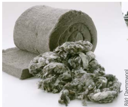
4 Auch Dämmstoffe aus Tierwolle kommen in der Regel nicht ohne Zusatzstoffe aus.
